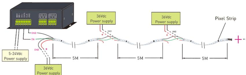
6.2 DMX wiring diagram.
